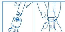
Para sondas de pH estándar y sondas de pH para suelo/plumas para suelo, coloque una cantidad suficiente de solución en la tapa de almacenamiento de la sonda (suficiente como para sumergir completamente la punta). Después, ponga la tapa de almacenamiento nuevamente en la sonda.
