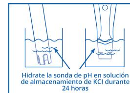
Hidrate la sonda de pH en solución de almacenamiento de KCl durante 24 horas
